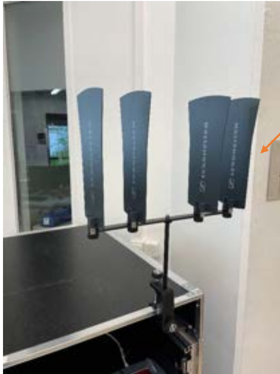
Antennen montiert an Rack
