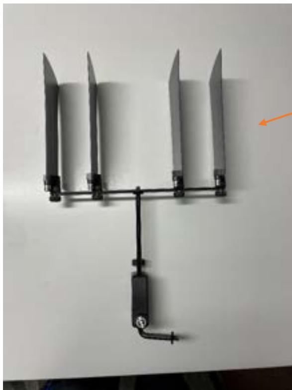
Antennen komplett zusammengebaut (exkl. Kabel)
