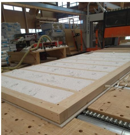
Dann wendet die Maschine das ganze Element und die Isolation kann eingeblasen werden, in diesem Fall der Marke Supafil wegen des Brandschutzes.
