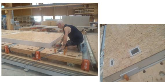
Wenn die Seitenwände angebracht sind, ist noch einmal Handarbeit gefragt. Da bekommen alle Elemente eine umlaufende Abdeckung. Ebenso müssen alle Öffnungen und Durchbrüche rundum abgeschlossen sein.
