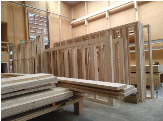
Aufgrund der Architekturpläne erstellt der Sachbearbeiter für jedes der Elemente einen individuellen Plan mit allen Öffnungen für Steckdosen, Lichtschalter, Kabelübergänge und Verbindungselemente. Dann wird zuerst für jedes Element eine Rahmenkonstruktion zusammengebaut. Diese muss das Gewicht gleichmäßig verteilen.
