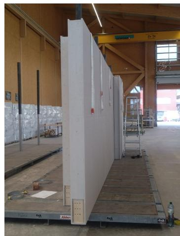
Die LKW-Pritsche füllt sich nach und nach mit fertigen Holzelementen. Sobald sie voll ist, wird sie witterfest verpackt und bis zum Transport auf die Baustelle zwischengelagert. Insgesamt 18 Pritschen werden bis zum Schluss gefüllt sein. Besonderes Augenmerk gilt hier dem Umstand, dass in einer sinnvollen Reihenfolge geladen wird, um dann auf der Baustelle die richtigen Elemente zur richtigen Zeit dabei zu haben.
