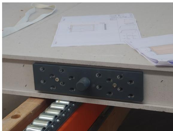
Zum Abschluss kommt dann noch das Stahlelement exakt an die vorgesehene Stelle, sodass später auf der Baustelle dann alles reibungslos ineinander passt. Damit ist das Element fertig vorbereitet und wird nun gelagert bis zum Transport auf die Baustelle.
