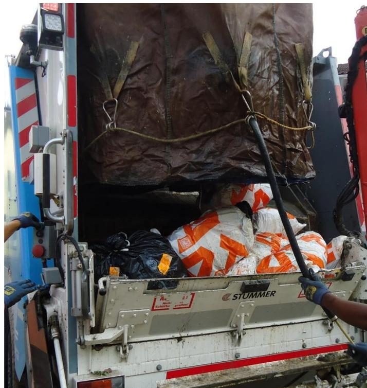
Durch Lösen des Zugseiles fallen die Säcke hinein.
